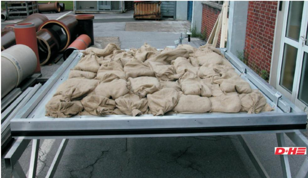
In der aktuellen Norm EN 12101-2 wird nicht zwischen einwärts und auswärts öffnenden Flügeln unterschieden. Ein einwärts öffnender Flügel wird durch eine von innen nach außen wirkende Last nur noch weiter in den Blendrahmen gedrückt. Hier sollte zumindest der durch die alte DIN 18232-3 vorgegebene Wert von  $WL = 1500$  erreicht werden.
