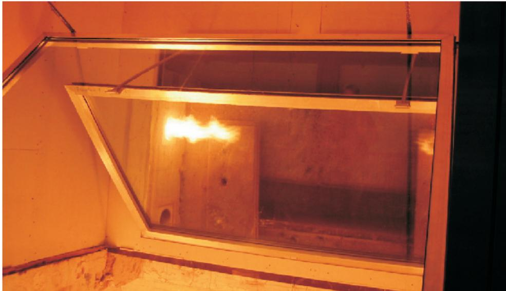
Die Prüfung gilt als bestanden, wenn sich nach der gesamten Beanspruchungsdauer von 30 Minuten die aerodynamisch wirksame Fläche um maximal 10% verringert hat. Im Falle einer stärkeren Verringerung gilt die Prüfung als nicht bestanden, da im Ernstfall nicht ausreichend Rauch aus dem Gebäude abgeführt werden kann.
