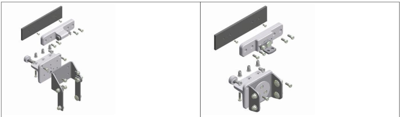
Damit die Abstützung der Rahmenkonsole am Riegel angewendet werden kann, muss die bauseitige Riegelkonstruktion eine Mindestdiefe von 100mm aufweisen. Ohne Abstützung ist nur eine Lasteinleitung von ca. 1500N möglich.
