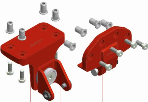
Lackierte Teile sind zur Verdeutlichung rot dargestellt. Schrauben und Splinte werden nicht lackiert.
