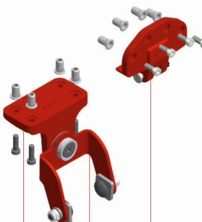
Lackierte Teile sind zur Verdeutlichung rot dargestellt. Schrauben und Splinte werden nicht lackiert.
